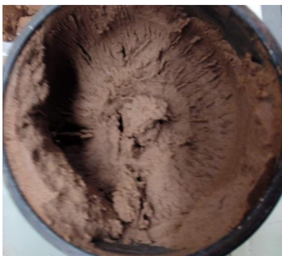
Рисунок 5 - Твердая фаза активации боксита, полученный при 200 °С и продолжительности 90 минут
